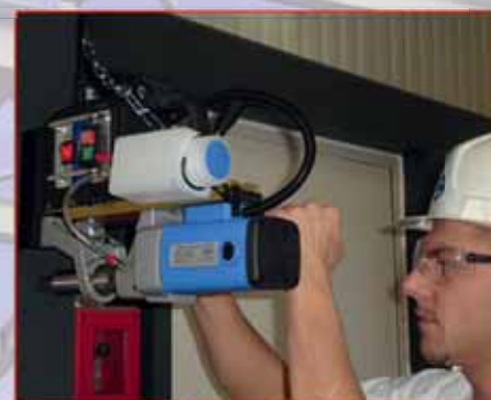
Automatische Kühlmittelzufuhr in allen Lagen Automatic coolant flow in all positions
